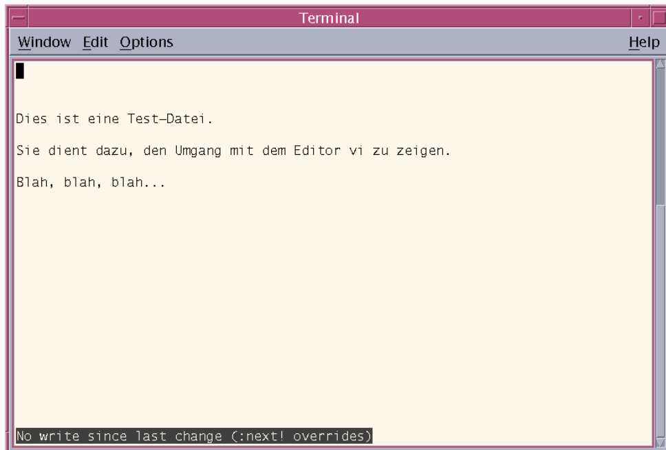
Abbildung 13: Fehlermeldung wegen nicht abgespeicherten Änderungen
